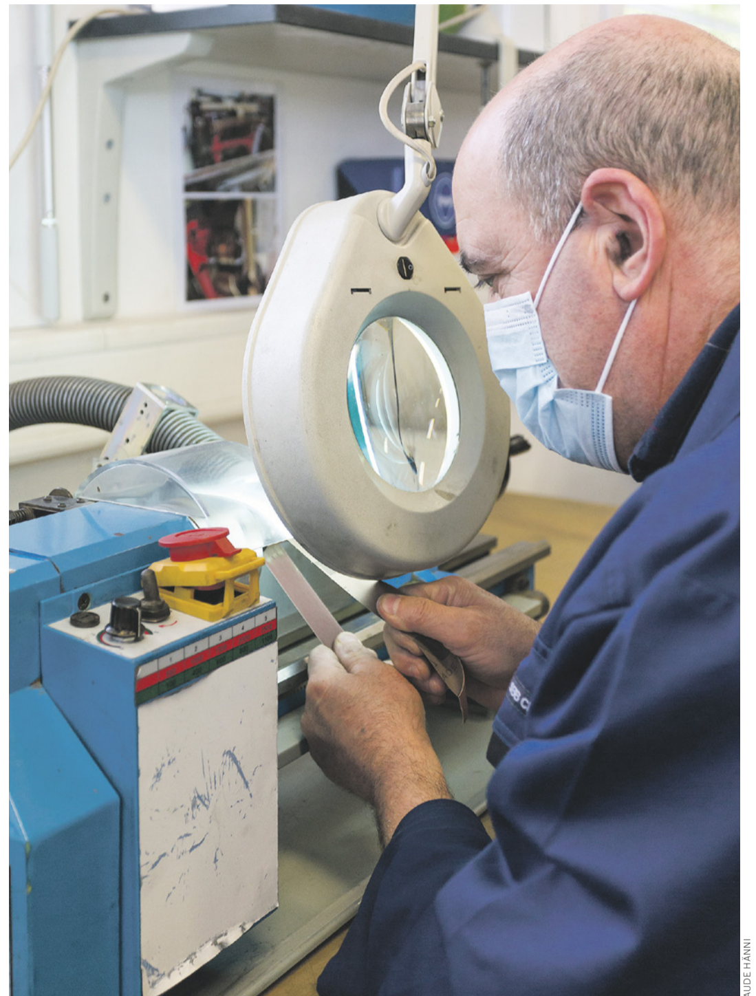
Das Polieren oxydierter Kontaktrollen der Elektromotoren von Weichen, die danach wieder für ein paar Jahre eingebaut werden, ist eine der vielfältigen Arbeiten bei Anyway in Penthalaz.
